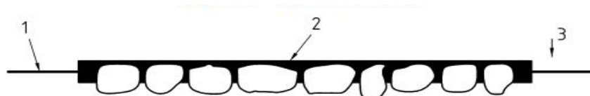
Рисунок 1с — Виступання в'язучого на поверхні щебеневої мозаїки (незадовільне проектування щодо застосування щебеню малого розміру, що спричинило його майже повне заглиблення у слабку основу, на якій влаштована поверхнева обробка тощо)
